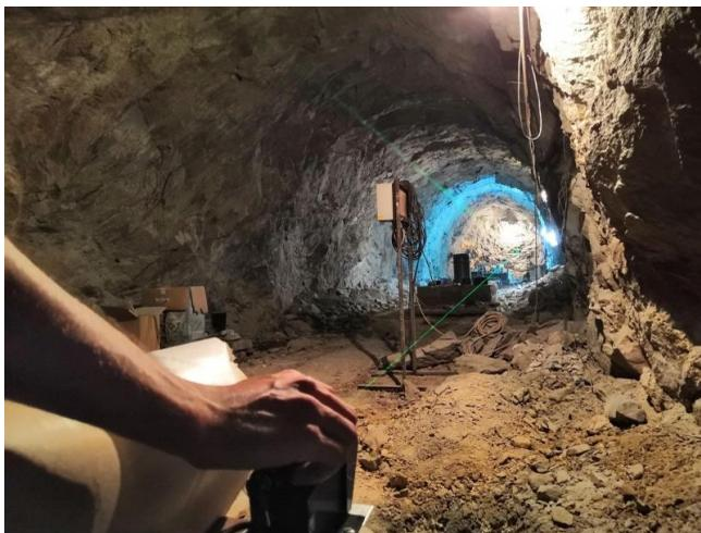
*«Горячий» тоннель Геофизической лаборатории №2 ИФЗ РАН в Баксанской нейтринной обсерватории. Зелёный пучок — визуализатор трассы лидарного зондирования аэрозолей*
