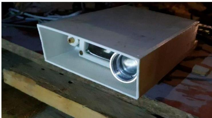
*Оптический приемо-передающий блок уникального компактного аэрозольного лидара, прототип которого был первым лидаром (лидаром РАН), доставленным на поверхность Марса миссией НАСА (США)*
